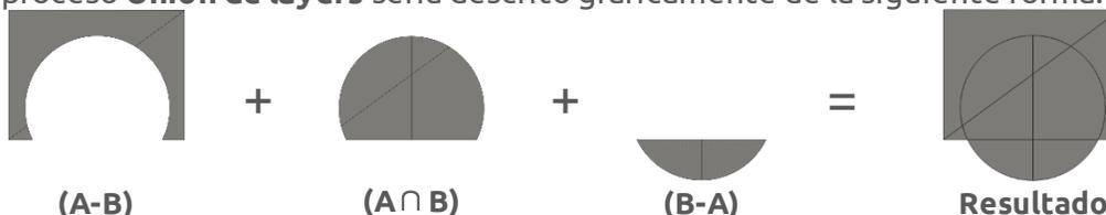
Estos pasos se realizan en queries separados y corridos secuencialmente. **El geoproceso Unión de layers es conmutativo**, pero las funciones ST\_Difference a usarse no lo serán, porque va a realizarse A – B y B – A, luego de la intersección  $A \cap B$ . La intersección  $A \cap B$  sí es conmutativa.
